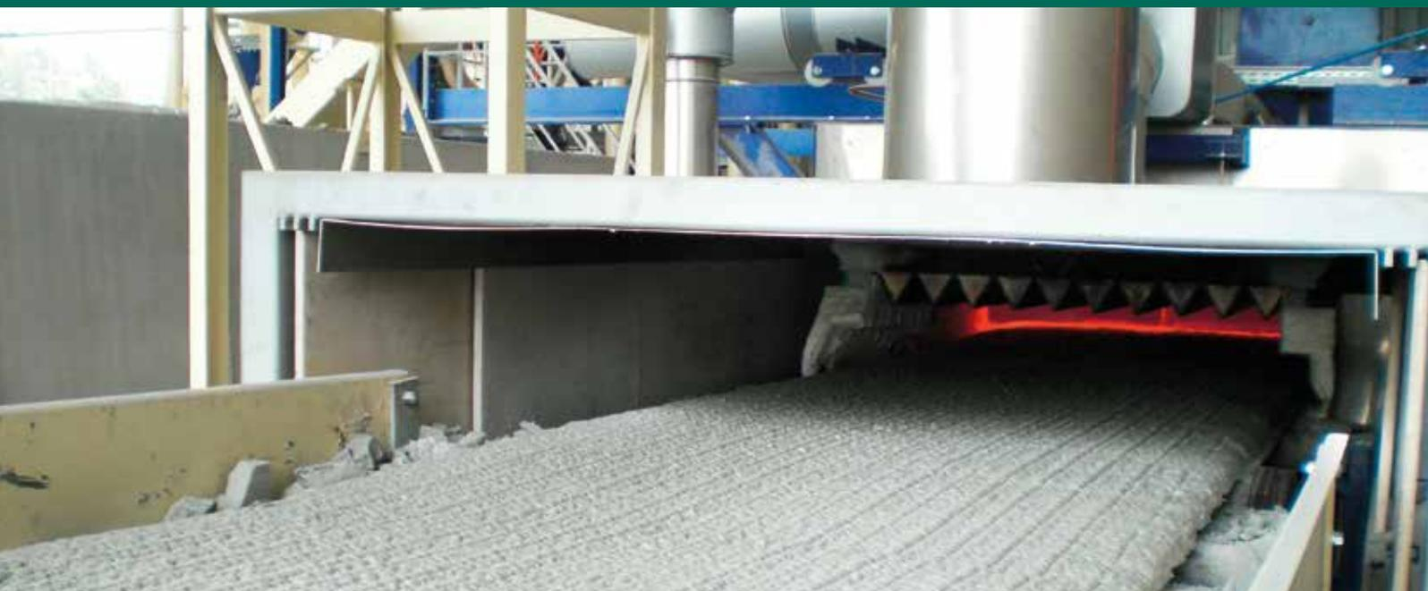
**SAVELPOR 50** è una schiuma di vetro ottenuta espandendo ad alta temperatura (800°C) polvere di vetro che proviene dal recupero di rottame di vetro altrimenti destinato a discarica, opportunamente trattato e additivato.
