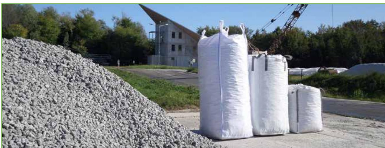
**Origine:** ghiaia in vetroschiuma prodotta attraverso processo termico e successivo raffreddamento rapido che ne provoca la frammentazione delle dimensioni di granelli di ghiaia.
